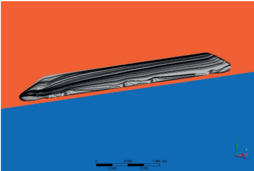
Figura 7 – Linee di flusso del treno ottimizzato che passa all'aria aperta. Figure 7 – Streamlines of optimized train passing in open air.
